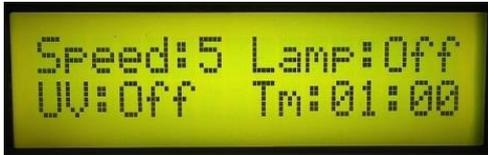
Blower SPEED 설정치, UV Lamp 상태, FL Lamp 상태, Timer 설정시간이 표시창에 나타납니다.
